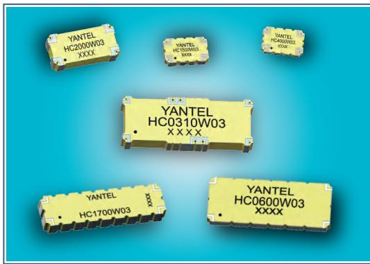
大功率宽带表贴式及嵌入式耦合器系列，实现微波大功率功放系统的功率合成分配，信号采集等功能。应用于有源相控阵雷达，微波收发组件、微波功放、电台、卫星通信等项目，提供标准化及特制化的高品质高可靠产品。性能及可靠性指标和国际产品对标，管脚定义和封装尺寸与国际产品兼容，实现100%原位替代。
