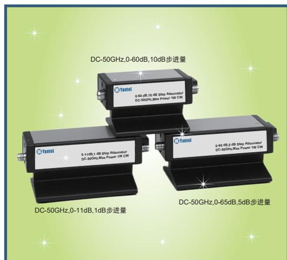
可编程步进衰减器可提供快速、精确的信号电平控制，频率高达50 GHz。这些衰减器损耗低、寿命长，可重复性强，可保护测试平台避免故障、重新校准、停机和生产损失。
