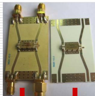
测试治具 测试PCB板
