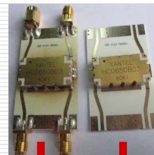
测试治具 测试PCB板
