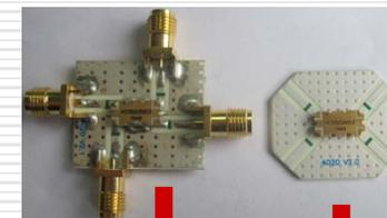
测试治具 测试PCB板
