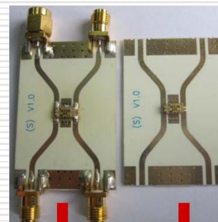
测试治具 测试PCB板
