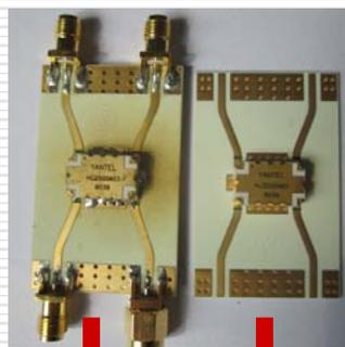
测试治具 测试PCB板
