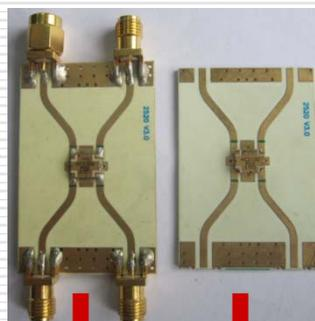
测试治具 测试PCB板
