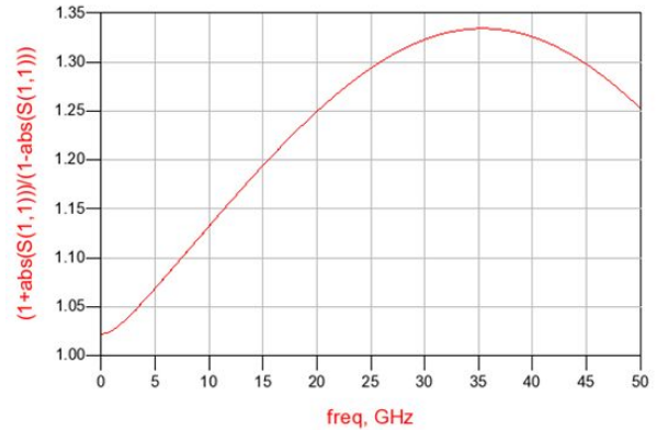
加 300um 双键合线的测试结果
